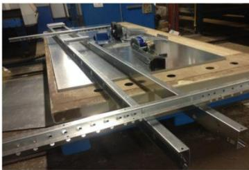
3. Поместите поперечные балки в желаемое место (например как на рисунке) и закрепите болтами M8x10.
