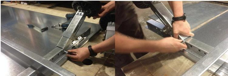
7. Прикрепите боковые опоры лодки к задней поперечине
