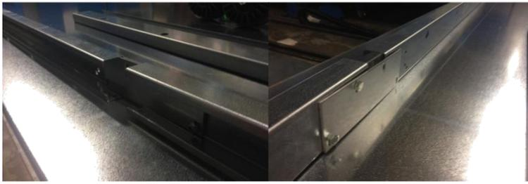
1. Вставьте длинные балки, как показано на рисунке, прикрепите опорные пластины к обеим сторонам балки и закрепите болтами M8x20.
